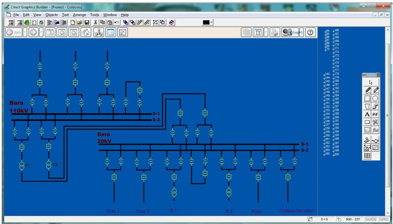
Dupa realizarea schemei anterioare, am plasat leduri, care se aprind daca linia respectiva este sub tensiune, si se sting daca linia este nealimentata.
